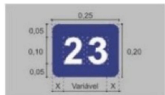
DETALHE NUMERAÇÃO DE VAGA CONFORME NORMA SEM ESCALA
